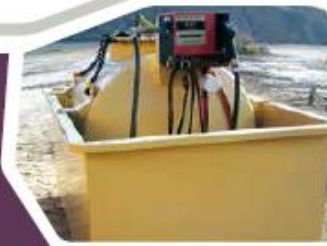
■ Cuve carburant mobile sur rétention
